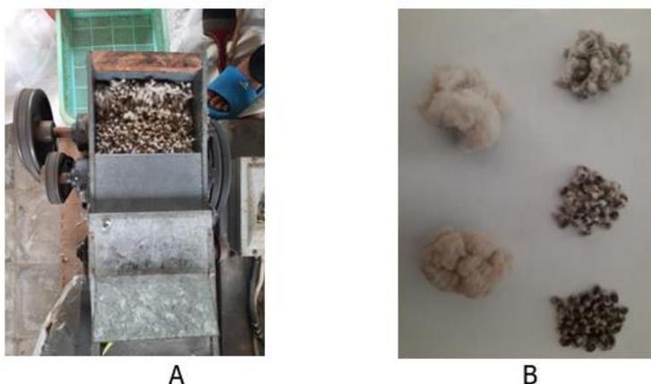
Gambar 17. A. Proses delinting biji kapas kabu-kabu menggunakan mesin delinting kecil. B (a) Biji kapas berkabu, (b) Serat linter kapas hasil delinting tahap I, (c) Biji kapas sisa pengambilan tahap I, (d) Serat linter kapas hasil delinting tahap II, (e) Biji kapas sisa pengambilan linter kapas
