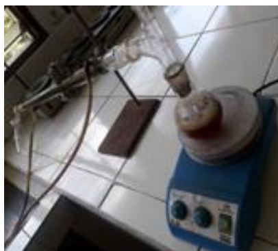
Gambar 62. Proses pirolisis debu sabut kelapa untuk produksi asap cair (kiri), proses redistilasi asap cair (kanan).
