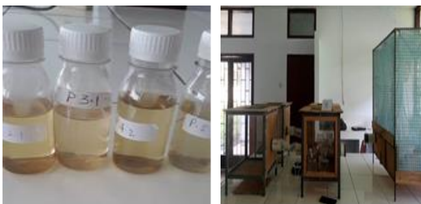
Gambar 63. Asap cair dari debu sabut kelapa setelah di redistilasi (kiri), pengujian asap cair sebagai bioinsektisida pada nyamuk (kanan).
